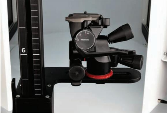
Die ultrapräzise einstellbare Kamerahalterung von Manfrotto verfügt für alle Bewegungsachsen über Winkelmesser, sodass sich Blickwinkel bei Bedarf immer wieder gleich einstellen lassen.
